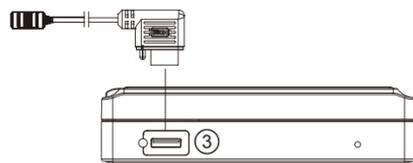
1. Stecken Sie das Controller-Kabel in die Controller-Buchse
