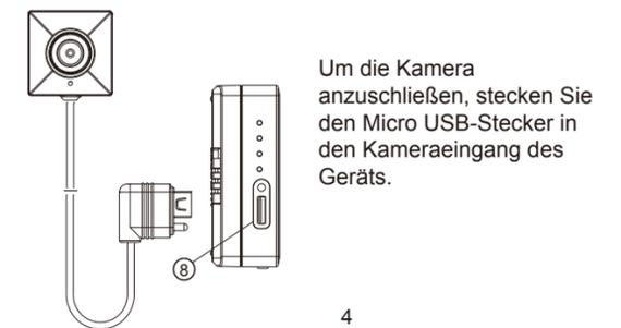
Um die Kamera anzuschließen, stecken Sie den Micro USB-Stecker in den Kameraeingang des Geräts.
