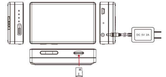
1. Verbinden Sie den Stecker des Ladegerätes mit der Gleichstromeingangsbuchse.
